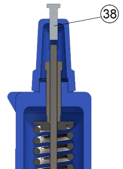
CONSTRUCCIÓN CON MORDAZA DE PRUEBA
